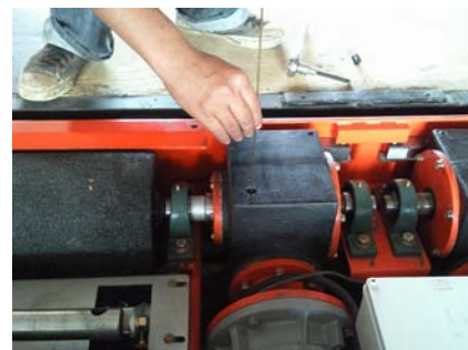
รูปที่ 35 ใช้เหล็กเส้นเล็กๆหรือไม้วัดระดับน้ำมัน
