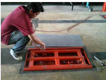
รูปที่ 46 ทำความสะอาดโดยการใช้นมเปล่า ทำความสะอาดภายใน
