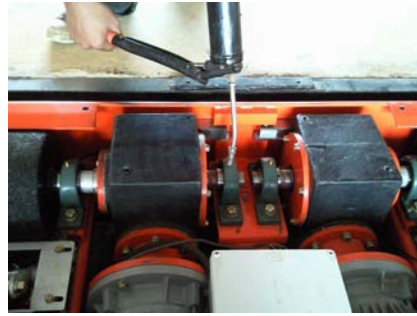
รูปที่ 37 การอัดจารบีตามลูกปืนมีทั้งหมด 10 ตัว
