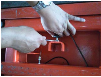
รูปที่ 48 ปรับตัวบังคับการเคลื่อนซ้าย-ขวา ด้านละประมาณ 10 มม.
