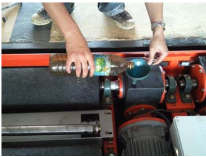
รูปที่ 38 ถ้ามีระดับความลึกน้อยกว่า 6 ซม.ให้เติม น้ำมันเกียร์เบอร์ 90 เข้าไป ดังรูป
