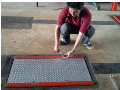
รูปที่ 44 ใช้ประแจเปิดฝาครอบโครงของเครื่อง วัดศูนย์ล้อ
