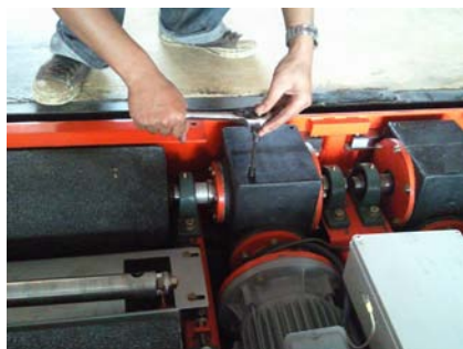
รูปที่ 34 เปิดน็อตบนเกียร์เพื่อตรวจเช็คระดับน้ำมันในห้องเกียร์ทด
