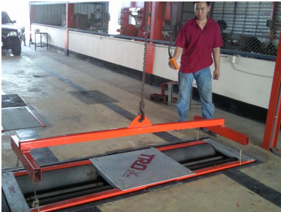
รูปที่ 2 แสดงการยกเครื่องจักรและการใช้อุปกรณ์ช่วยยก
