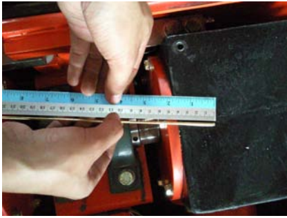
รูปที่ 36 นำมาเทียบกับไม้บรรทัดต้องมีระดับ ไม่น้อยกว่า 6 ซม.
