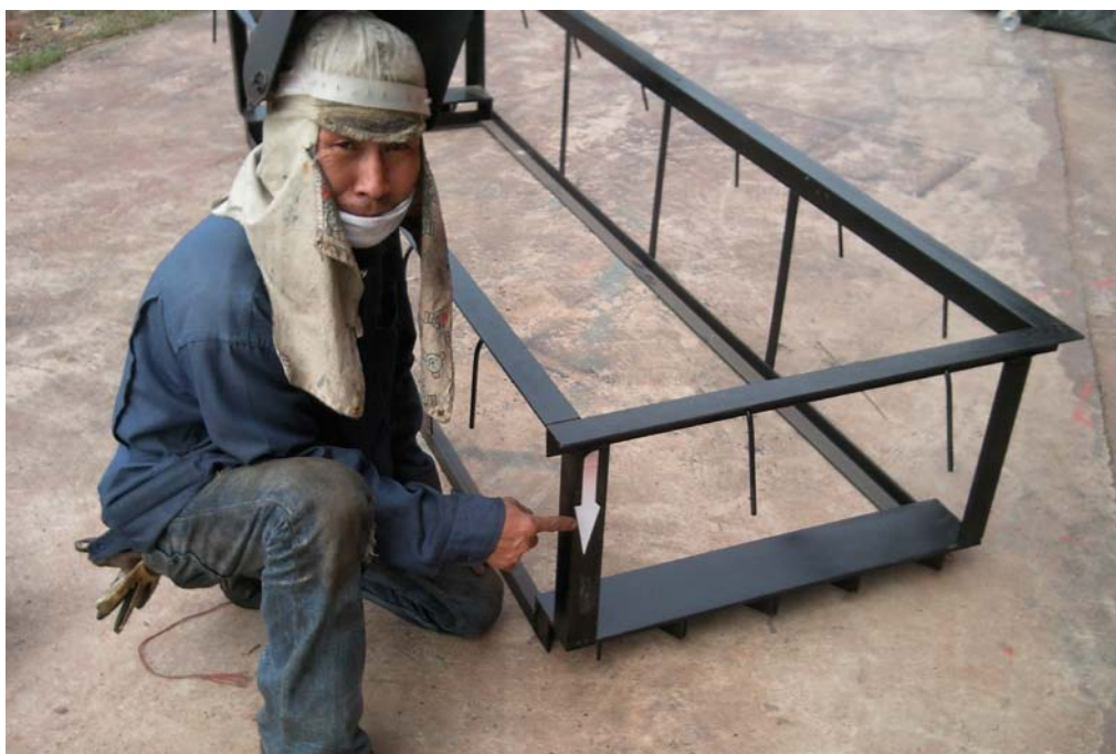
รูปที่ 6 โครงเหล็กของเครื่องทดสอบประสิทธิภาพห้ามล้อรถยนต์
